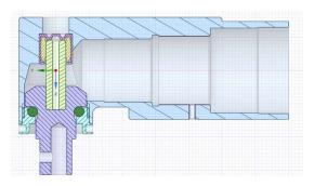
使用乾冰將插銷冷卻至 -200°F(華氏), 擦乾水氣後塗上 Loctite 638 螺絲膠,並 將插銷裝入錐齒輪中
